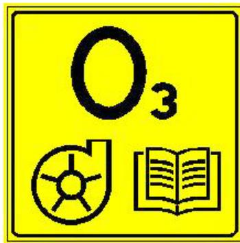
2. O processo de tratamento produz o gás ozônio como um subproduto. É responsabilidade do cliente garantir que a unidade esteja conectada a um sistema de extração adequado ou a um conversor catalítico construído com materiais resistentes à corrosão. As saídas de extração de ozônio são identificadas pela etiqueta acima. (Consulte o Apêndice 1.)
