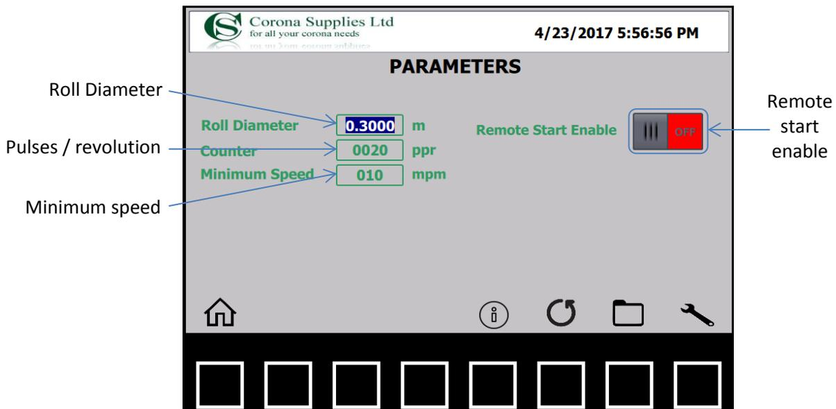
Roll Diameter - Diameter of the treater roller (meters).
