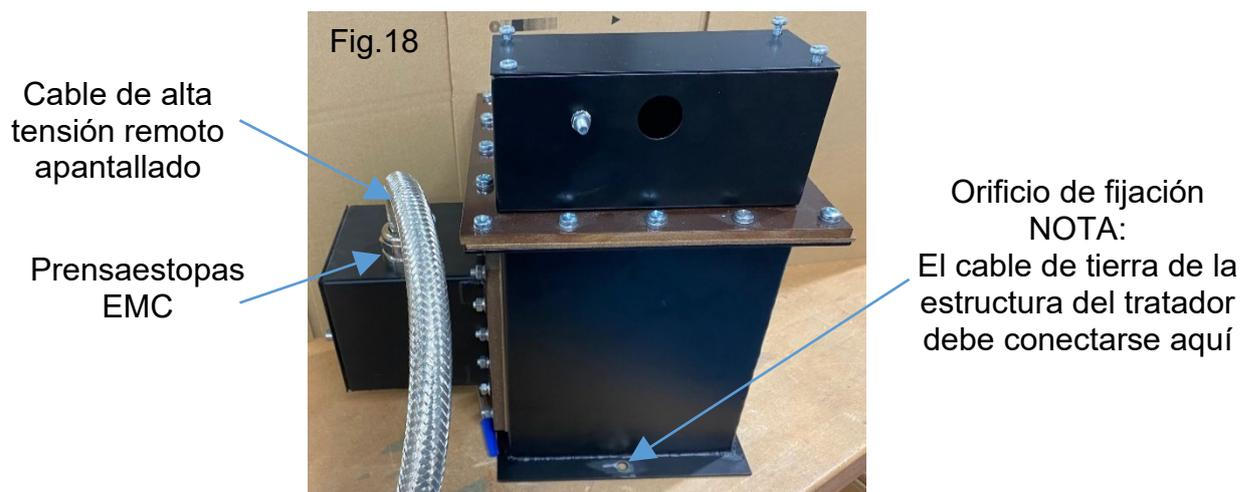
El transformador de AT remoto debe montarse en posición vertical y fijarse al armazón de la línea de producción mediante los orificios de fijación de la base Fig.18.
