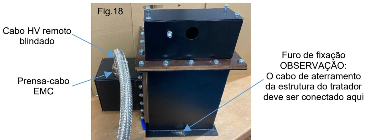
O transformador remoto HV deve ser montado na posição vertical e fixado à estrutura da linha de produção usando os orifícios de fixação na base Fig. 18.
