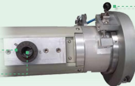
Manete para rotacionar o cartucho de eletrodos em 180° para uma limpeza rápida e fácil manutenção. Este sistema não interrompe a conexão com o transformador de alta tensão, eliminando a possibilidade de mal contato e desgaste.
