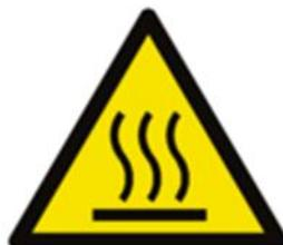
Los electrodos y rodillos cerámicos / metálicos alcanzan temperaturas superiores a 150° C durante el funcionamiento. Cualquier trabajo en el interior de la estación de tratamiento corona sólo debe realizarse después de que los electrodos / rodillos hayan tenido tiempo de enfriarse. La corona debe detenerse y el ventilador de extracción debe dejarse en funcionamiento durante aproximadamente 10 minutos antes de abrir la máquina y retirar las cubiertas.
